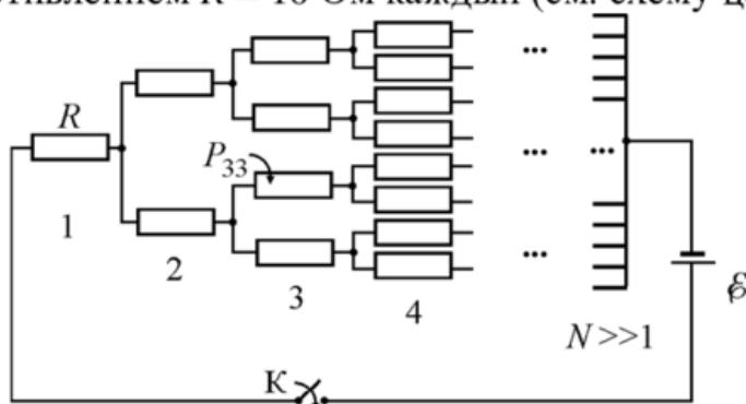
Левый вывод цепи он присоединил к «минусу» идеальной батареи с ЭДС  $\varepsilon = 12 \text{ В}$ . В этой цепи на каждом следующем «шаге» (номер 1, 2, 3, 4, ...,  $N \gg 1$ ) к правому концу каждого резистора присоединяются параллельно ещё два резистора, а в конце цепи все правые выводы резисторов присоединяются к «плюсу» батареи. Какая мощность  $P_{33}$  будет выделяться на третьем сверху резисторе из 3-го «шага» цепи после замыкания ключа К? (Этот резистор показан на схеме стрелкой.)
