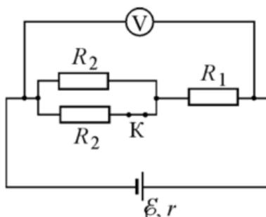
Определите, на какую величину изменится показание вольтметра, если разомкнуть ключ.
