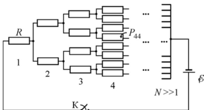
Левый вывод цепи он присоединил к «минусу» идеальной батареи с ЭДС  $\varepsilon = 12 \text{ В}$ . В этой цепи на каждом следующем «шаге» (номер 1, 2, 3, 4, ...,  $N \gg 1$ ) к правому концу каждого резистора присоединяются параллельно ещё два резистора, а в конце цепи все правые выводы резисторов присоединяются к «плюсу» батареи. Какая мощность  $P_{44}$  будет выделяться в четвертом сверху резисторе из 4-го «шага» цепи после замыкания ключа К? (Этот резистор показан на схеме стрелкой.)
