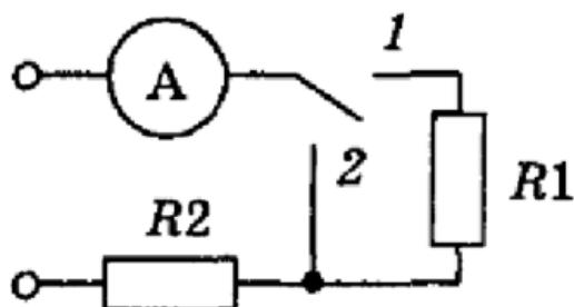
Чему равно сопротивление проводника  $R1$ , если напряжение на зажимах цепи  $U = 12 \text{ V}$ ?
