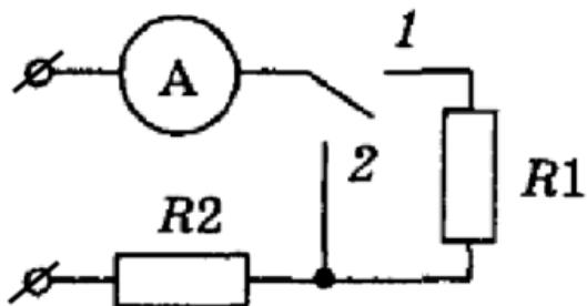
Чему равно сопротивление проводника  $R1$ , если напряжение на зажимах цепи  $U = 27$  В?
