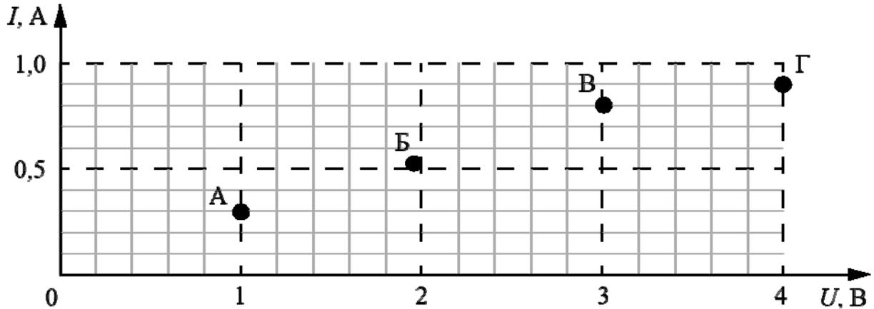
Какие из четырёх измерений (А–Г) соответствуют закону Ома для участка цепи с учётом погрешности измерений? В ответе запишите буквенные обозначения всех этих точек на графике.
